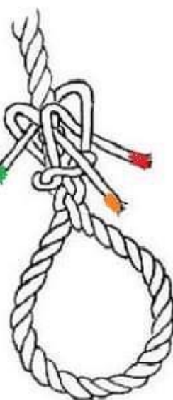
C/ Puis faire un noeud tête mort, comme le schéma, vers le bas
